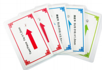
随设备附送金属检测机测试卡 包含铁、非铁(铜)、不锈钢材质的金属球 可用于日常测试灵敏度与审核认证
