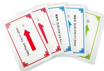
随设备附送金属检测机测试卡
