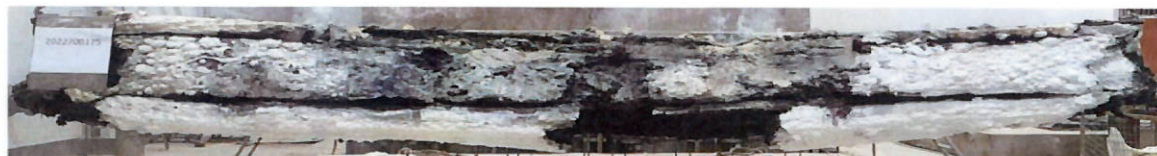
照片 2 耐火试验结束时试件情况
