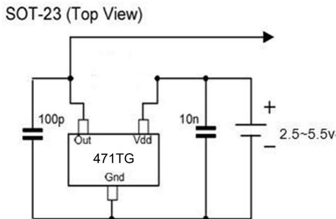
低功耗全极型超高灵敏 CMOS 输出霍尔开关
