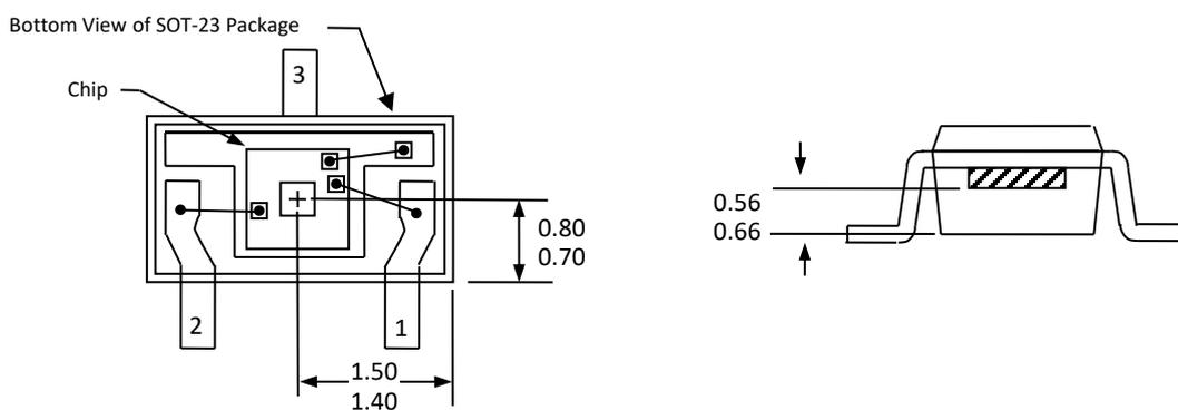
低功耗全极型超高灵敏 CMOS 输出霍尔开关
