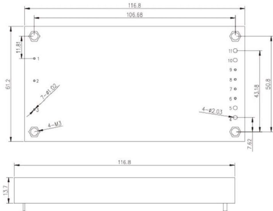
注: 模块的管脚间距、安装定位尺寸公差为±0.25mm(±0.01inch), 其他外型尺寸公差为±0.5mm(±0.02inch);
