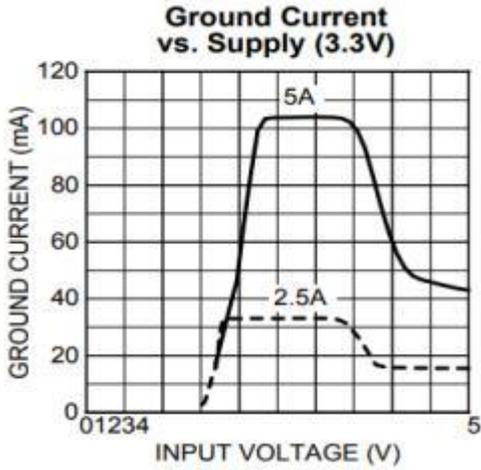
图 5 地引脚电流与输入电压曲线(3.3V)
