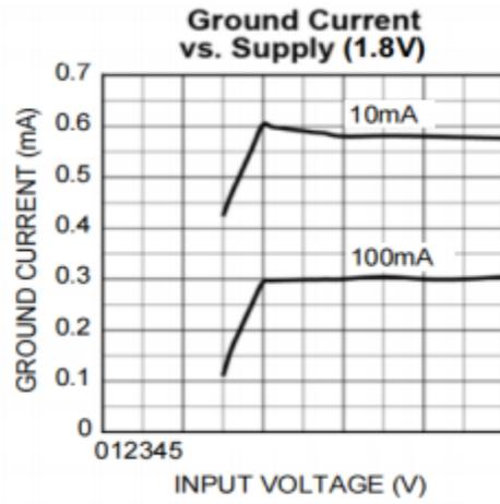
图 10 地引脚电流与输入电压曲线(1.8V)
