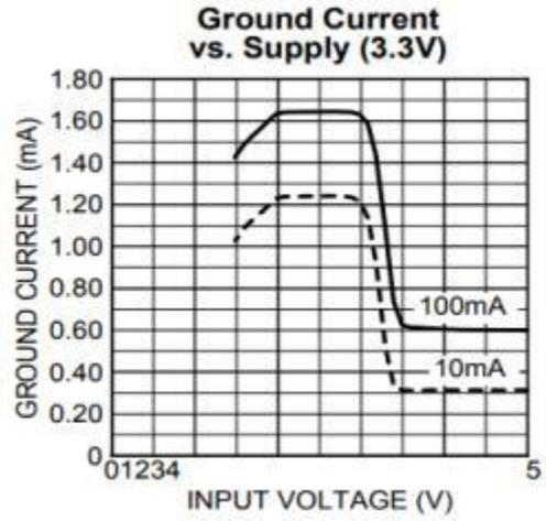
图 4 地引脚电流与输入电压曲线(3.3V)
