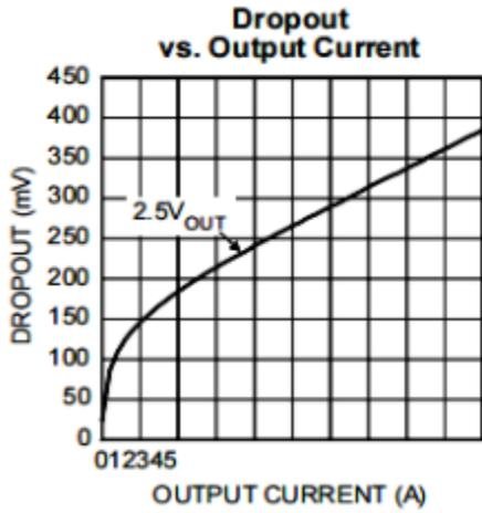
图 15 漏失电压与输出电流曲线
