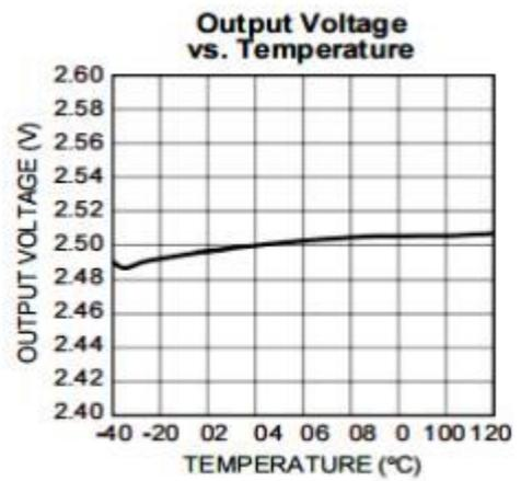
图 18 输出电压与温度曲线(2.5V)
