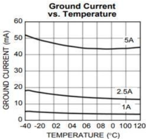
图 7 地引脚电流温度特性曲线
