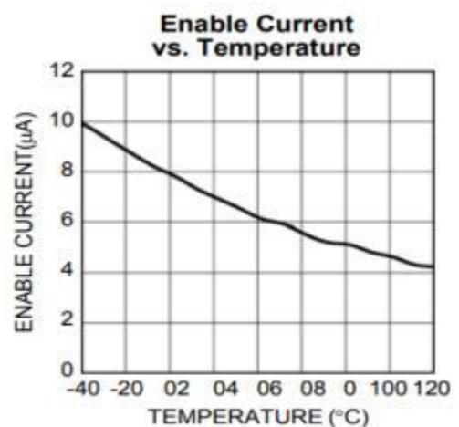
图 8 使能端电流温度特性曲线
