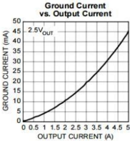
图 17 地引脚电流与输出电流曲线
