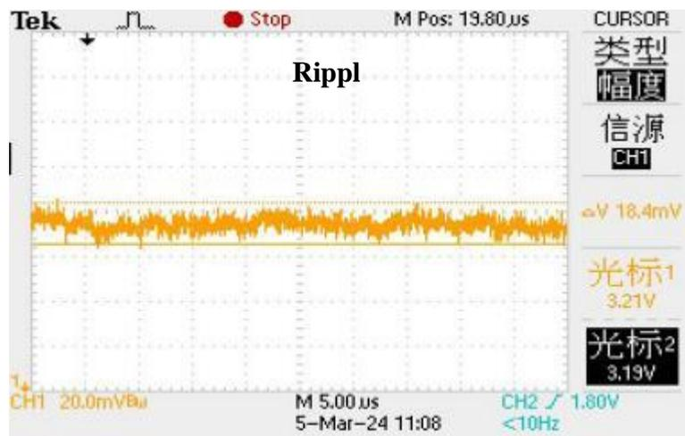
图 22 纹波特性曲线 (3.3V 输出)
