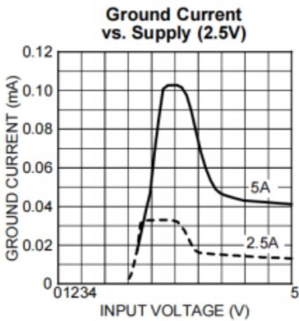
图 13 地引脚电流与输入电压曲线(2.5V)
