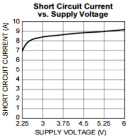
图 19 短路电流与输入电压曲线
