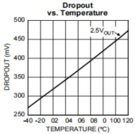
图 16 漏失电压与温度曲线
