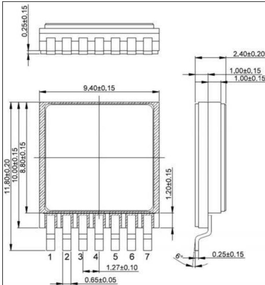
图 24 C-SIP-7 封装外形尺寸图
