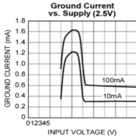
图 14 地引脚电流与输入电压曲线(2.5V)
