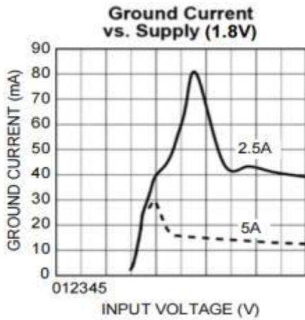
图 11 地引脚电流与输入电压曲线(1.8V)
