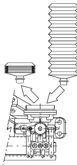
3) 用手将油脂瓶罩按顺时针方向转动到转不动为止。
