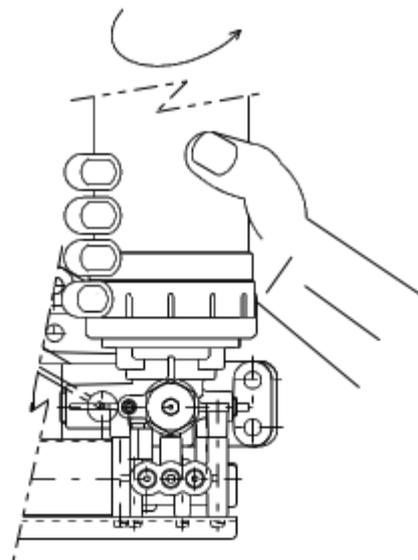
2) 将空的油脂瓶按逆时针方向转动并取下。
