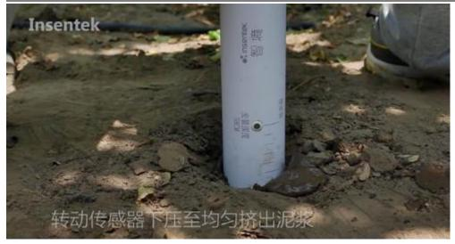
• (3)安装好后按下设备按钮的同时向右转动,然后按下快速启动按钮,等待安装完的第一包监测数据的发出(等待时间一般为 3-5 分钟)
