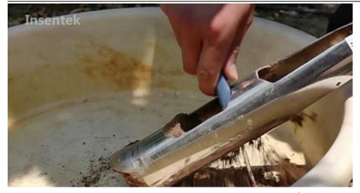
• (3)重复前两个步骤,并将传感器在打孔过程中轻放入孔洞中(请勿将设备用力触底),测试一下打孔的质量。若有卡顿,则用取土钻修正一下,保证放入取出比较顺畅,直到孔深与传感器所标识的安装位置齐平为止(若为砂土,则打孔深度要略深一点)。
