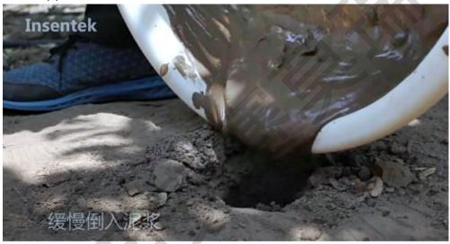
• (2)将传感器慢慢放入孔洞中,向一个方向转动并下压(此过程不允许上提),当传感器安装到正确的深度后,设备周围会溢出一些泥浆,此时安装完成。(泥浆一定要有溢出,才能将孔洞内部的空气全部排出来)
