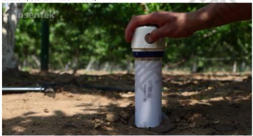
• **(4)**按完快速启动按钮后往回转动头部至原状并再次按下向左转动到太阳能接口状态**(**不需要太阳能供电板的用户则不需要操作此步骤**)**
