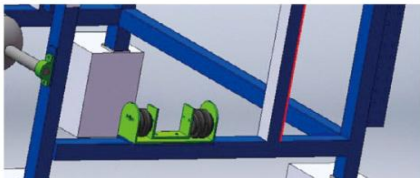
27、将纠偏座安装于机架上
