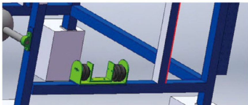
27、将纠偏座安装于机架上
