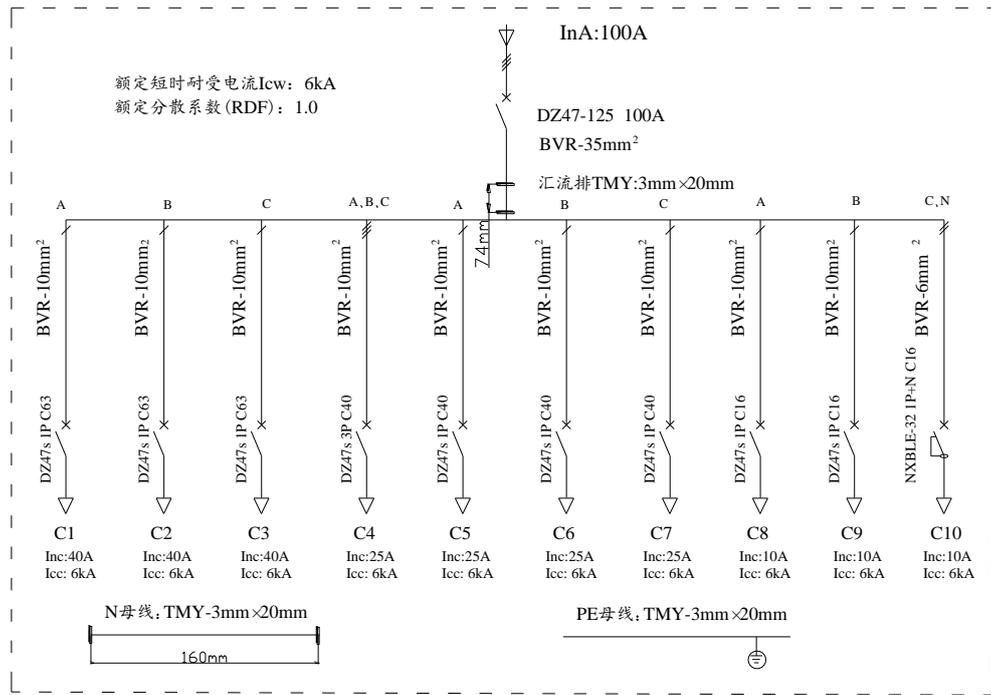
三相汇流排绝缘子: 6个; N 母线绝缘子: 2个
