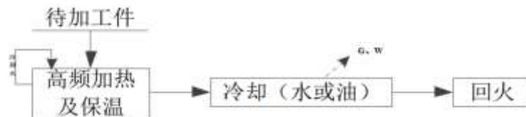
图 3- 16 高频淬火工艺流程及产污节点
