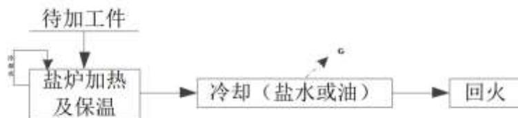
图 3-10 盐炉淬火工艺流程及产污节点
