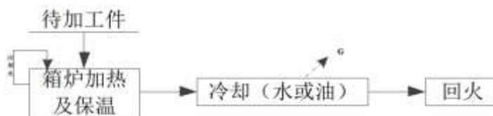
图 3- 11 箱炉淬火工艺流程及产污节点
