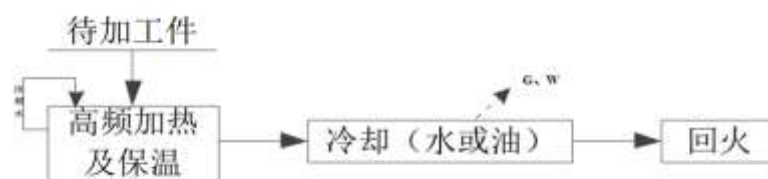
图 2-16 高频淬火工艺流程及产污节点
