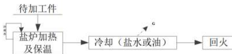
图 2-10 盐炉淬火工艺流程及产污节点
