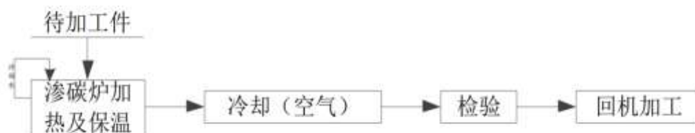
图 2-17 渗碳工艺流程及产污节点
