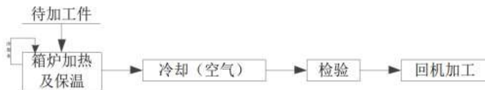
图 2- 12 箱炉退火工艺流程及产污节点
