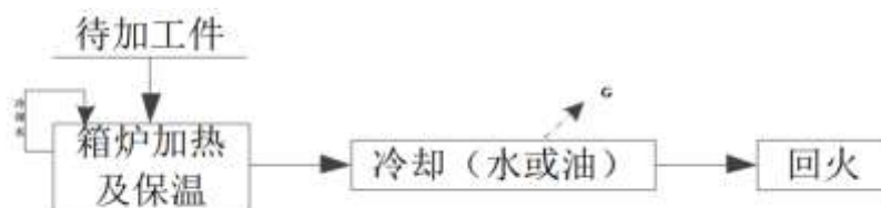
图 2-11 箱炉淬火工艺流程及产污节点
