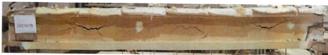
照片 2 耐火性能试验结束时试件情况
