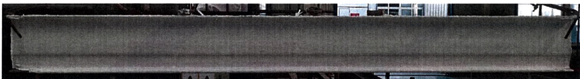
图片 1 耐火试验前构件情况
