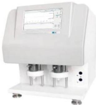
★1.检测通道：双通道检测，一个工作站可以实现 2-32 个通道自由切换模式。
